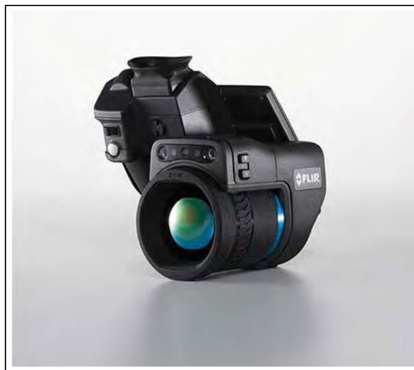
写真-1 撮影に使用した赤外線カメラの外観
